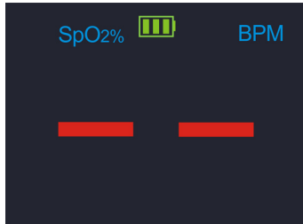
Gerät zur Messung bereit, Finger nicht eingeführt
